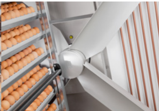
与托盘回转方向平行流动的空气涡流
