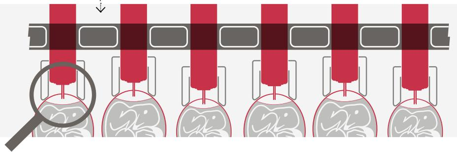
**3** 允许注射深度自动和单独地适应每个胚胎(无论种蛋大小和种群周龄),每个注射器中的内针单独下降。
