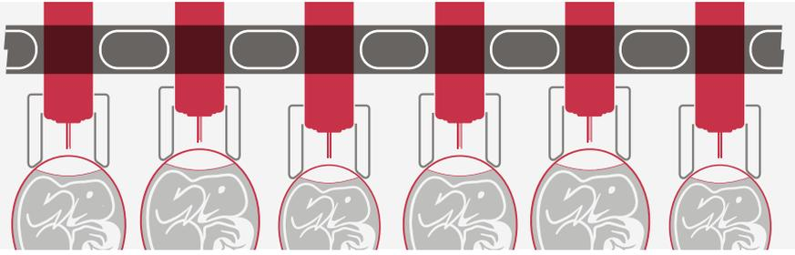
**2** 注射器之间的特殊空气管充气膨胀,将注射器锁定在理想位置。然后注射头进行第二次固定的向下运动,使注射器的外针整体而精确地刺穿外壳。
