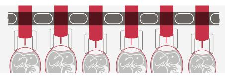
Tubos especiales de aire entre los inyectores se inflan y bloquean los inyectores en la posición ideal. Seguidamente, el cabezal del inyector hace un segundo movimiento descendente fijo, lo que hace que las agujas exteriores del inyector perforen la carcasa de forma conjunta y precisa.
