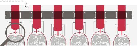
Para permitir la adaptación automática e individual de la profundidad de inyección en cada embrión (independientemente del tamaño del huevo y la edad del lote), las agujas internas de cada inyector descienden individualmente.
